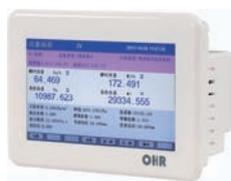
OHR-T560系列触摸彩色流量无纸记录仪采用新型大规模集成电路，对输入、输出、电源、信号采取可靠保护和强抗干扰设计。3路万能输入（可组态选择输入：标准电压、标准电流、热电偶、热电阻、频率、毫伏等）其中可带1路流量输入。具有继电器报警输出，馈电输出，流量积算，温压补偿功能；可带RS485通讯接口，以太网接口，微型打印机接口和USB接口，SD卡插座；具有强大的显示功能，实时曲线显示，历史曲线追忆，棒图显示，报警状态显示，流量显示。
