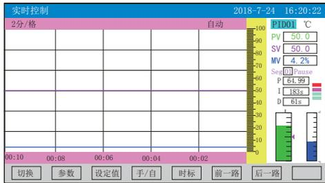
实时控制：可实时显示与控制相关的曲线和参数
