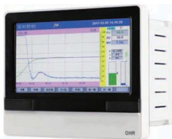
OHR-XH300C/H300C系列8路触摸彩色调节无纸记录仪采用真正的人工智能算式，仪表启动自整定功能，可以根据被控对象的特性，自动寻找最优参数以达到很好的控制效果，无需人工整定参数。控温精度基本达 $\pm 0.1^{\circ}\text{C}$ ，无超调、欠调，达国际先进水平。24路万能输入（可组态选择输入：标准电压、标准电流、热电偶、热电阻、毫伏等）其中可带8路控制输入。可带8路控制输出或12路变送输出或12限报警输出，RS232/485通讯接口，以太网接口，微型打印机接口和USB接口，SD卡插座；可提供传感器配电；具有强大的显示功能，实时曲线显示，历史曲线追忆，棒图显示，报警状态显示。
