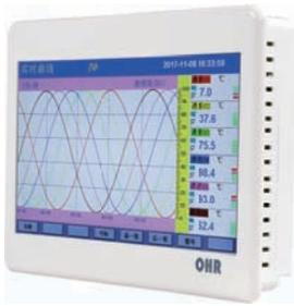
OHR-T910系列超薄大屏无纸记录仪采用新型大规模集成电路，对输入、输出、电源、信号采取可靠保护和强抗干扰设计。10路万能信号输入（可组态选择输入：标准电压、标准电流、热电偶、热电阻、频率、毫伏等）。可带4路报警输出，1个馈电输出，RS485通讯接口，以太网接口，微型打印机接口和USB接口，SD卡插座；可提供传感器配电；具有强大的显示功能，实时曲线显示，历史曲线追忆，棒图显示，报警状态显示。
