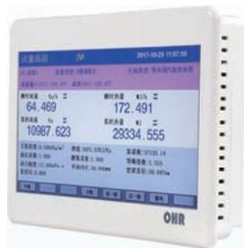
OHR-T960系列超薄大屏流量无纸记录仪采用新型大规模集成电路，对输入、输出、电源、信号采取可靠保护和强抗干扰设计。6路万能输入（可组态选择输入：标准电压、标准电流、热电偶、热电阻、频率、毫伏等）其中可带2路流量输入。具有继电器报警输出、变送输出，馈电输出，流量积算，温压补偿功能；可带RS485通讯接口，以太网接口，微型打印机接口和USB接口，SD卡插座；具有强大的显示功能，实时曲线显示，历史曲线追忆，棒图显示，报警状态显示，流量显示。
