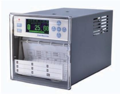
OHR-H900系列液晶有纸记录仪是专业针对工业现场设计的多功能智能记录仪。提供8路高精度模拟信号万能输入通道，可配置8路报警，可提供传感器配电；采用高精度热敏打印机，实现高精度数据、曲线或混合打印；具有高清晰宽视角液晶显示功能，提供实时数据单屏、多屏、棒图等显示，提供报警状态显示；人性化的外观设计、完美的功能体现、可靠的硬件品质、精湛的制造工艺，使本产品具有完美的性价比。
