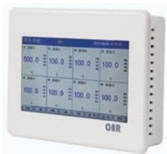
OHR-T710系列触摸超薄无纸记录仪采用新型大规模集成电路，对输入、输出、电源、信号采取可靠保护和强抗干扰设计。8路万能信号输入（可组态选择输入：标准电压、标准电流、热电偶、热电阻、频率、毫伏等）。可带4路报警输出，1个馈电输出，RS485通讯接口，以太网接口，微型打印机接口和USB接口，SD卡插座；可提供传感器配电；具有强大的显示功能，实时曲线显示，历史曲线追忆，棒图显示，报警状态显示。
