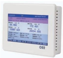
OHR-T760系列触摸超薄流量无纸记录仪采用新型大规模集成电路，对输入、输出、电源、信号采取可靠保护和强抗干扰设计。6路万能输入（可组态选择输入：标准电压、标准电流、热电偶、热电阻、频率、毫伏等）其中可带2路流量输入。具有继电器报警输出、变送输出，馈电输出，流量积算，温压补偿功能；可带RS485通讯接口，以太网接口，微型打印机接口和USB接口，SD卡插座；具有强大的显示功能，实时曲线显示，历史曲线追忆，棒图显示，报警状态显示，流量显示。
