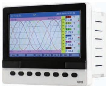
OHR-XH700/H700系列48路彩色数据采集无纸记录仪用新型大规模集成电路，对输入、输出、电源、信号采取可靠保护和强抗干扰设计。48路万能输入（可组态选择输入：标准电压、标准电流、热电偶、热电阻、毫伏等）。可带RS232/485通讯接口，以太网接口，微型打印机接口和USB接口，SD卡插座；可提供传感器配电；具有强大的显示功能，实时曲线显示，历史曲线追忆，棒图显示等。人性化的外观设计、完美的功能体现、可靠的硬件品质、精湛的制造工艺，使本产品具有更高的性能价格比。
