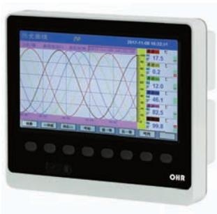
OHR-F800系列彩色无纸记录仪采用新型大规模集成电路，对输入、输出、电源、信号采取可靠保护和强抗干扰设计。12路万能信号输入（可组态选择输入：标准电压、标准电流、热电偶、热电阻、频率、毫伏等）。可带12路报警输出，6个变送输出，RS485通讯接口，以太网接口，微型打印机接口和USB接口，SD卡插座；可提供传感器配电；具有强大的显示功能，实时曲线显示，历史曲线追忆，棒图显示，报警状态显示。
