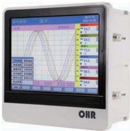
OHR-K700系列触摸数据采集控制工作站采用新型大规模集成电路，对输入、输出、电源、信号采取可靠保护和强抗干扰设计。70路万能信号输入（可组态选择输入：标准电压、标准电流、热电偶、热电阻、毫伏等）。可带20限报警输出，14路变送输出，6路DI输入，RS232/485通讯接口，以太网接口，微型打印机接口和USB接口，SD卡插座；可提供传感器配电；具有强大的显示功能，实时曲线显示，历史曲线追忆，棒图显示，报警状态显示。
