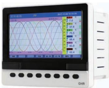
OHR-XH700F/H700F系列24路无补偿彩色流量无纸记录仪用新型大规模集成电路，对输入、输出、电源、信号采取可靠保护和强抗干扰设计。24路万能输入（可组态选择输入：标准电压、标准电流、热电偶、热电阻、毫伏等）。可带RS232/485通讯接口，以太网接口，微型打印机接口和USB接口，SD卡插座；可提供传感器配电；具有强大的显示功能，实时曲线显示，历史曲线追忆，棒图显示等。人性化的外观设计、完美的功能体现、可靠的硬件品质、精湛的制造工艺，使本产品具有更高的性能价格比。
