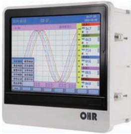
OHR-K100系列触摸中长图彩色无纸记录仪采用新型大规模集成电路，对输入、输出、电源、信号采取可靠保护和强抗干扰设计。14路万能信号输入（可组态选择输入：标准电压、标准电流、热电偶、热电阻、毫伏等）。可带20限报警输出，14路变送输出，6路DI输入，RS232/485通讯接口，以太网接口，微型打印机接口和USB接口，SD卡插座；可提供传感器配电；具有强大的显示功能，实时曲线显示，历史曲线追忆，棒图显示，报警状态显示。
