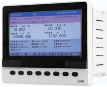
OHR-XH600/H600系列8路彩色流量无纸记录仪采用新型大规模集成电路,对输入、输出、电源、信号采取可靠保护和强抗干扰设计。24路万能输入(可组态选择输入:标准电压、标准电流、热电偶、热电阻、频率、毫伏等)其中可带8路流量输入。具有继电器报警输出,变送输出,流量积算,温压补偿功能;可带RS232/485通讯接口,以太网接口,微型打印机接口和USB接口,SD卡插座;可提供传感器配电;具有强大的显示功能,实时曲线显示,历史曲线追忆,棒图显示,报警状态显示,流量显示。
