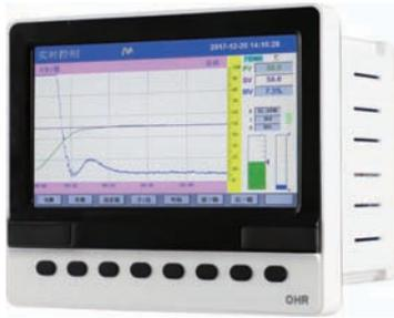
OHR-XH300/H300系列8路彩色调节无纸记录仪采用真正的人工智能算式，仪表启动自整定功能，可以根据被控对象的特性，自动寻找最优参数以达到很好的控制效果，无需人工整定参数。控温精度基本达 $\pm 0.1^{\circ}\text{C}$ ，无超调、欠调，达国际先进水平。24路万能输入（可组态选择输入：标准电压、标准电流、热电偶、热电阻、毫伏等）其中可带8路控制输入。可带8路控制输出或12路变送输出或18限报警输出，RS232/485通讯接口，以太网接口，微型打印机接口和USB接口，SD卡插座；可提供传感器配电；具有强大的显示功能，实时曲线显示，历史曲线追忆，棒图显示，报警状态显示。
