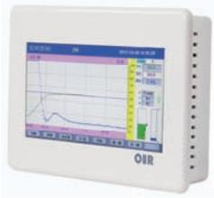
OHR-T730系列触摸超薄调节无纸记录仪采用真正的人工智能算法，仪表启动自整定功能，可以根据被控对象的特性，自动寻找最优参数以达到很好的控制效果，无需人工整定参数。控温精度基本达 $\pm 0.1^{\circ}\text{C}$ ，无超调、欠调，达国际先进水平。4路万能信号输入（可组态选择输入：标准电压、标准电流、热电偶、热电阻、频率、毫伏等）。可带2路PID控制，带2路报警输出，2个模拟量或开关量控制输出，2路DI电平输入，RS485通讯接口，以太网接口，微型打印机接口和USB接口，SD卡插座；可提供传感器配电；具有强大的显示功能，实时曲线显示，历史曲线追忆，棒图显示，报警状态显示。
